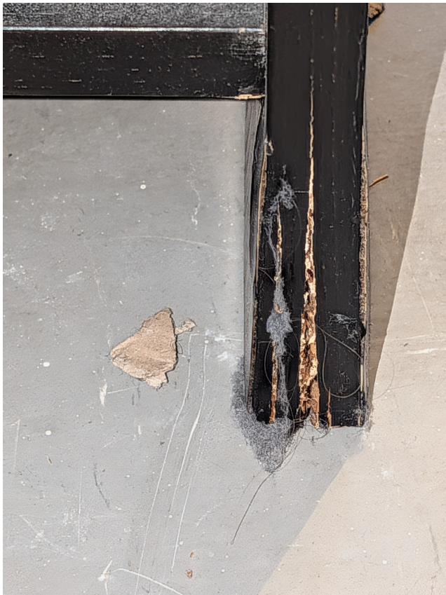
Figure 6: Aufquellung durch Abwasser Schreibtischplatte
