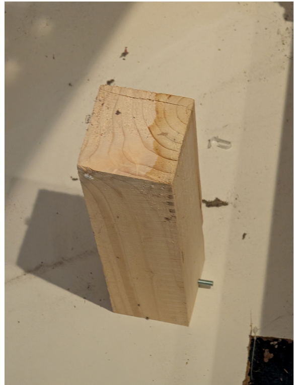
Figure 4: Stütze für Lattenrost mit Anhaftung von Abwasser
