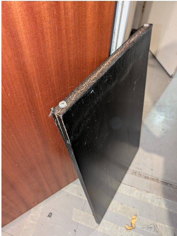
Figure 8: Aufquellung durch Abwasser bei zerlegter Schreibtischplatte
