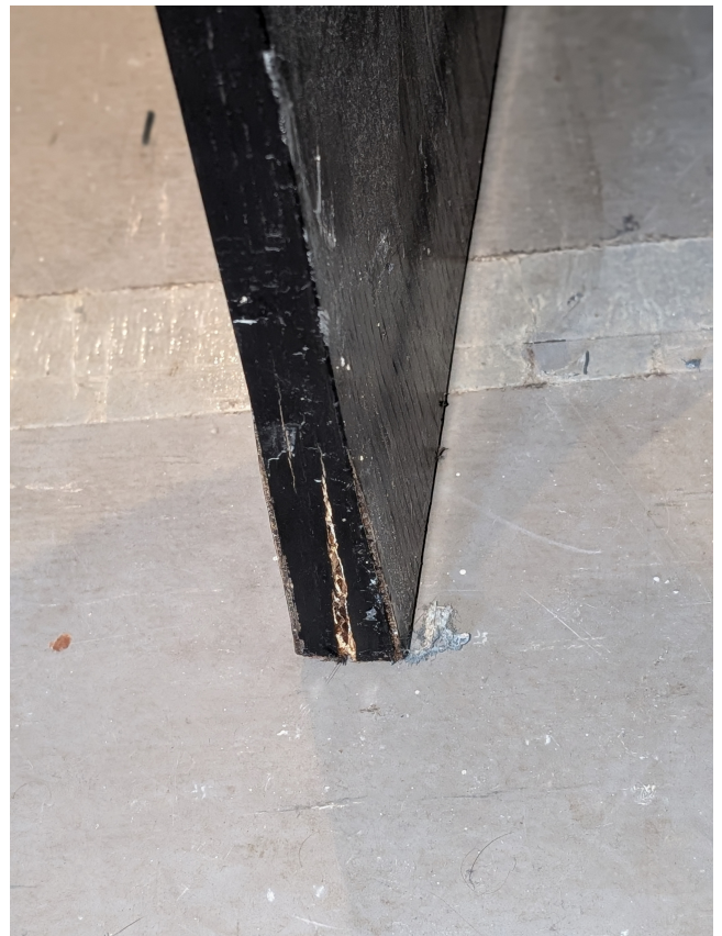
Figure 7: Aufquellung durch Abwasser Schreibtischplatte
