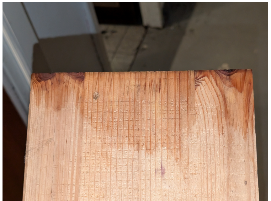
Figure 18: Holzunterlage in Abwasserpflütze unter Schreibtisch vorgefunden
